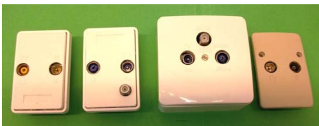
Vægstikdåser, den længst til højre er ikke godkendt
